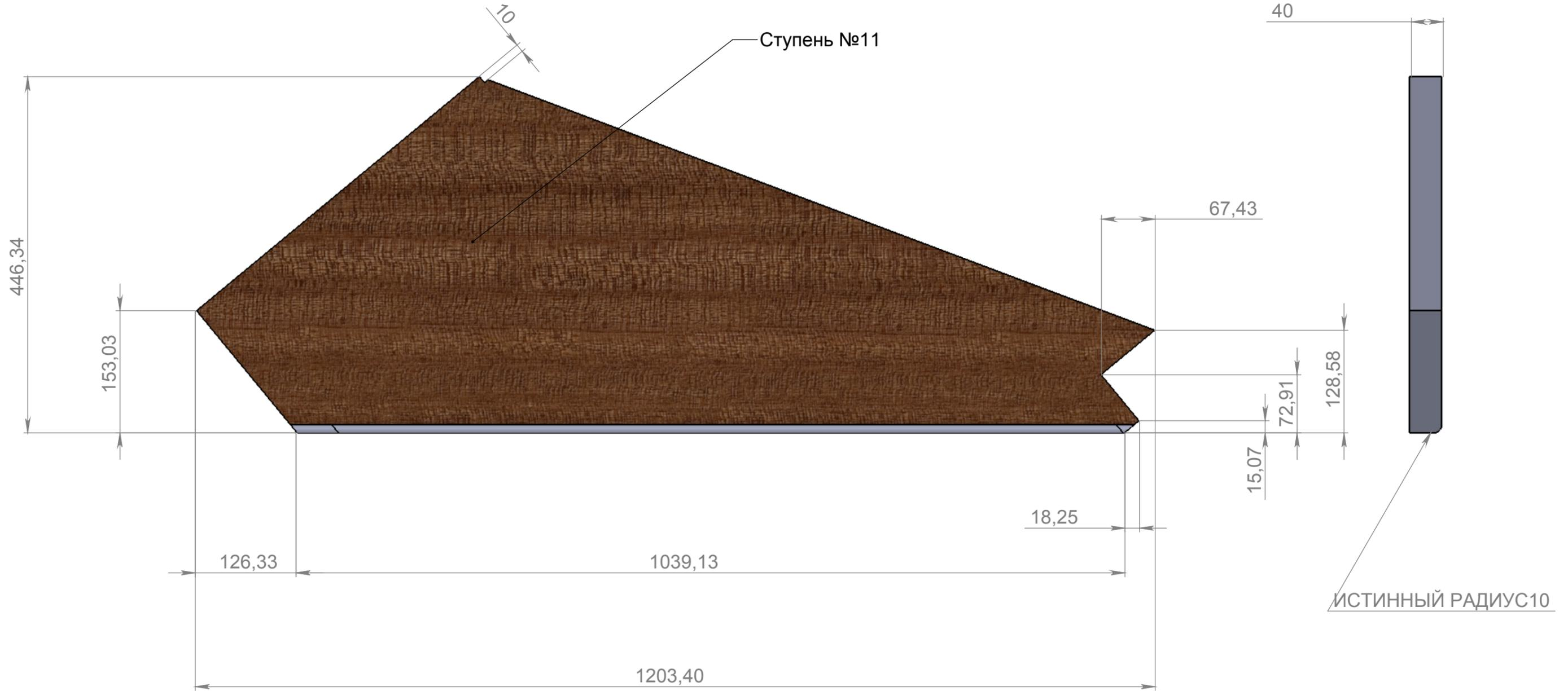
Направление волокон древесины должно быть параллельно передней кромке ступеней. Как на чертеже.
