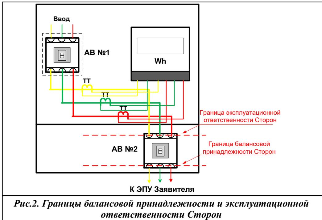
Шкаф учета может быть установлен на опоре ВЛ или территории участка Заявителя (фасад здания и т.д.), в зависимости от наличия энергопринимающего устройства.
