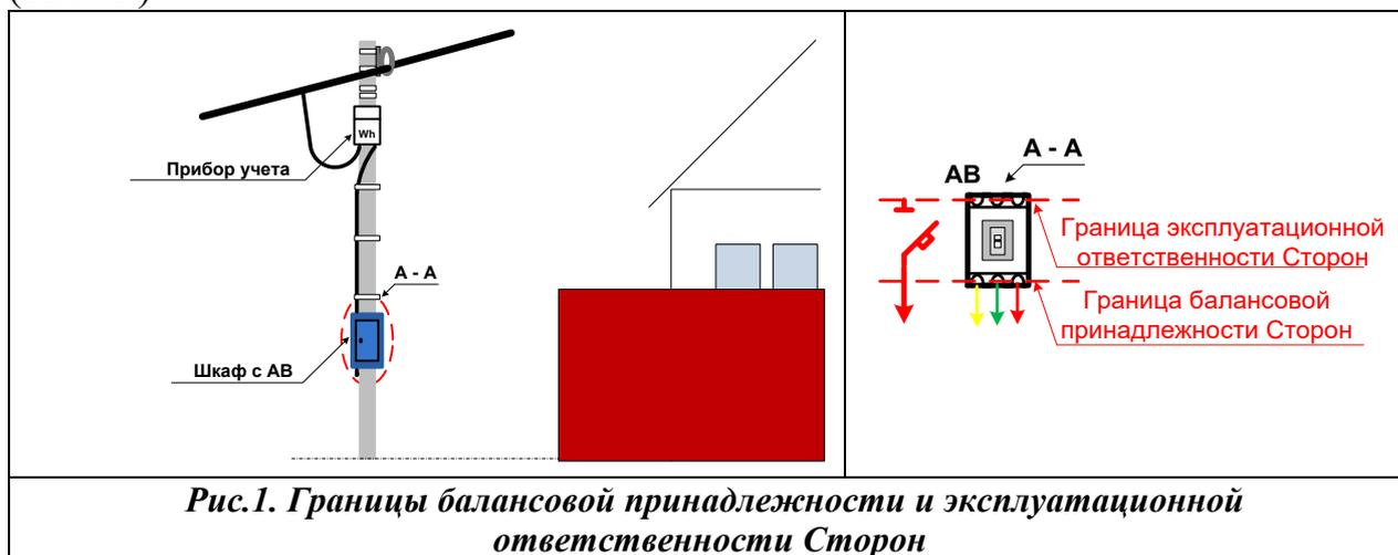
Для данного варианта технологического присоединения, прибор учета электроэнергии, как для однофазного, так и для трехфазного подключения, в зависимости от конструктивного исполнения, размещается на вершине опоры, от которой осуществляется ввод на участок.
