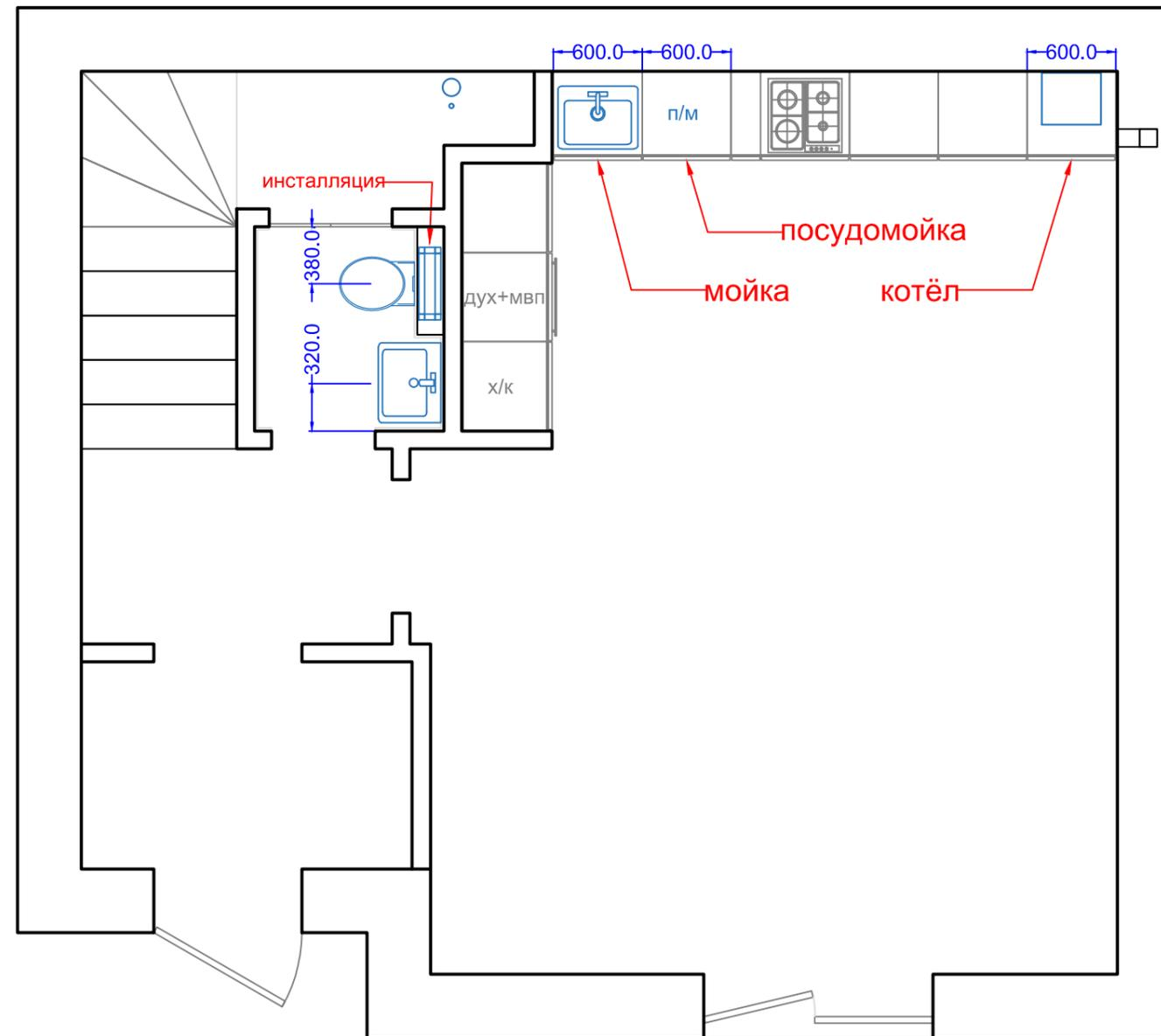
ПЛАН РАЗМЕЩЕНИЯ САНТЕХНИЧЕСКОГО ОБОРУДОВАНИЯ. 2 ЭТАЖ.
