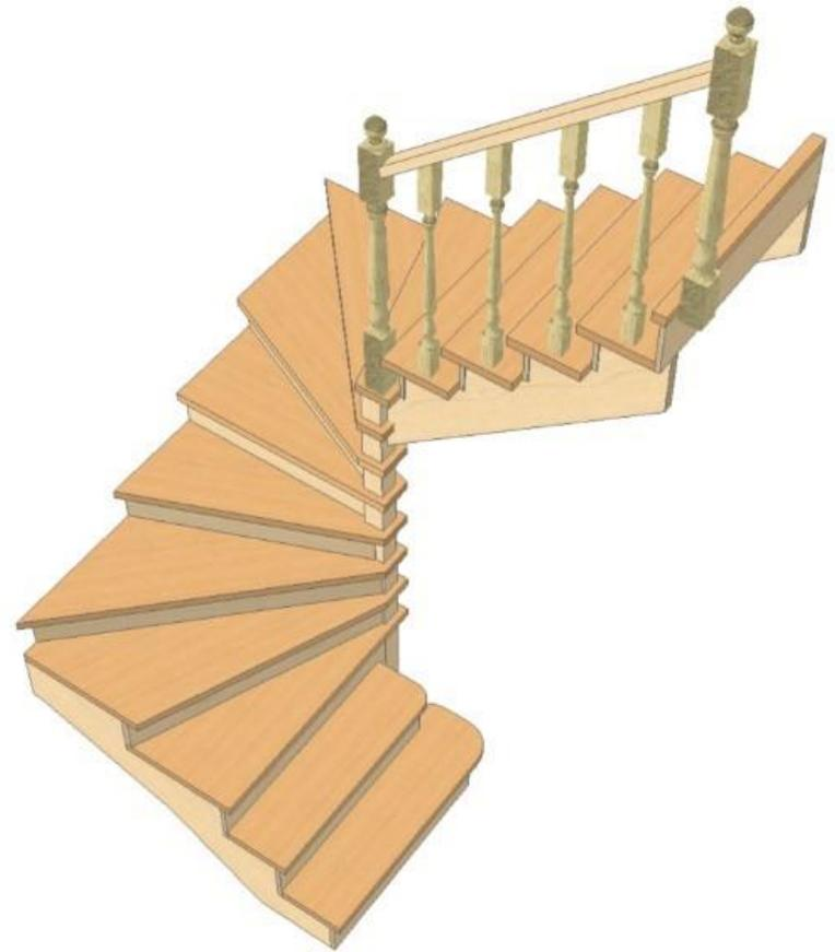
На втором этаже нужны перила - ограждение до стены как на рисунке (точно также вправо), окончание просто в стену. Длину ограждения легко рассчитать после уточнения размеров лестницы и оси выхода верхнего перила (ориентировочно 90см)
