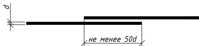
Продольный стык арматуры
