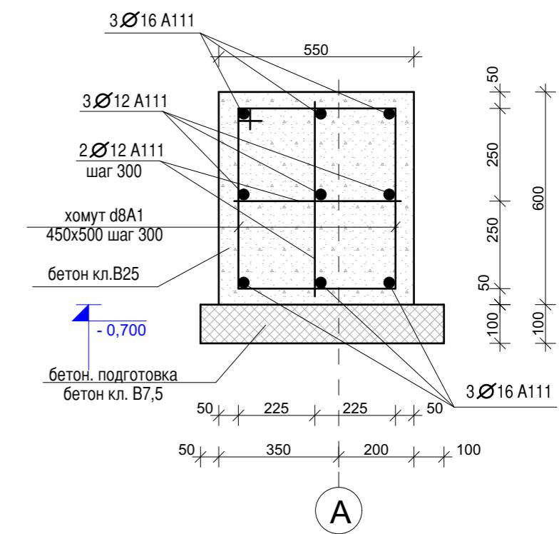
1. Боковые поверхности фундаментов, соприкасающиеся с грунтом обмазать горячим битумом за два раза
